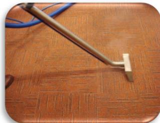
カーペットに蓄積された汚れを、高温、高圧で洗浄し同時に汚水を回収していきます。エクストラクターとは比較にならない仕上がりが期待ができます。
